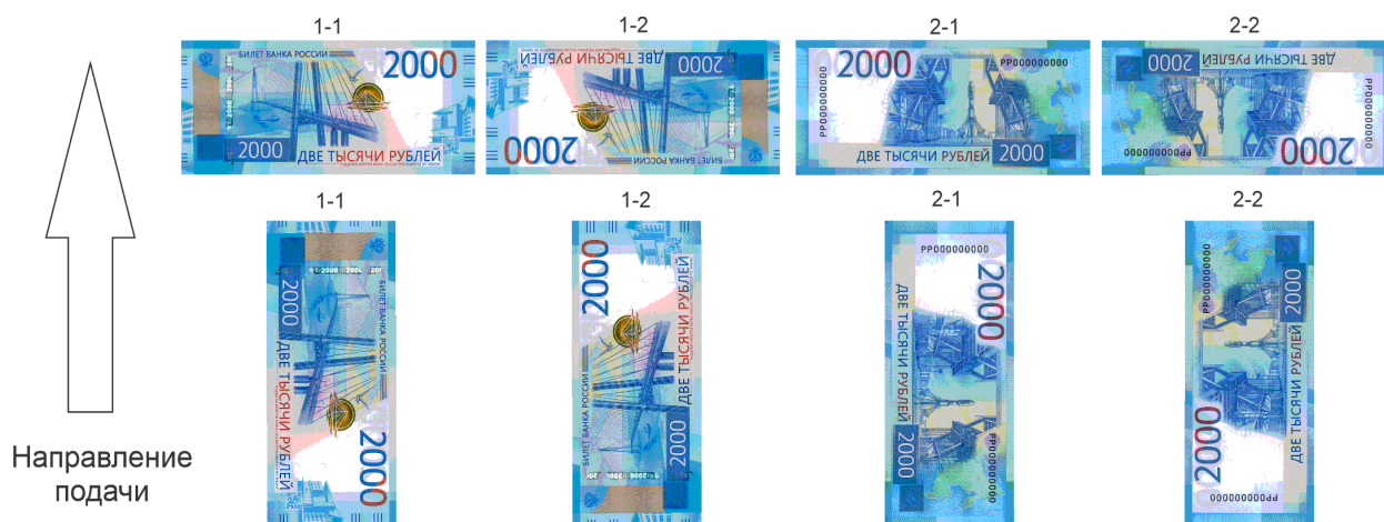
Рис.1. Ориентация банкноты при различном направлении подачи
