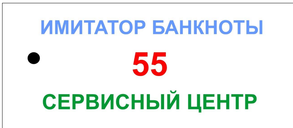
Рис.11 Пример тестового образца имитатора банкноты по ветхости с отверстием
