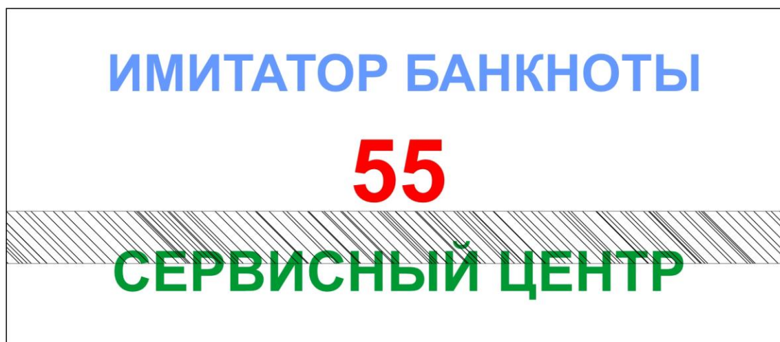
Рис.13 Пример тестового образца имитатора банкноты по ветхости с наличием на поверхности клеящей ленты
