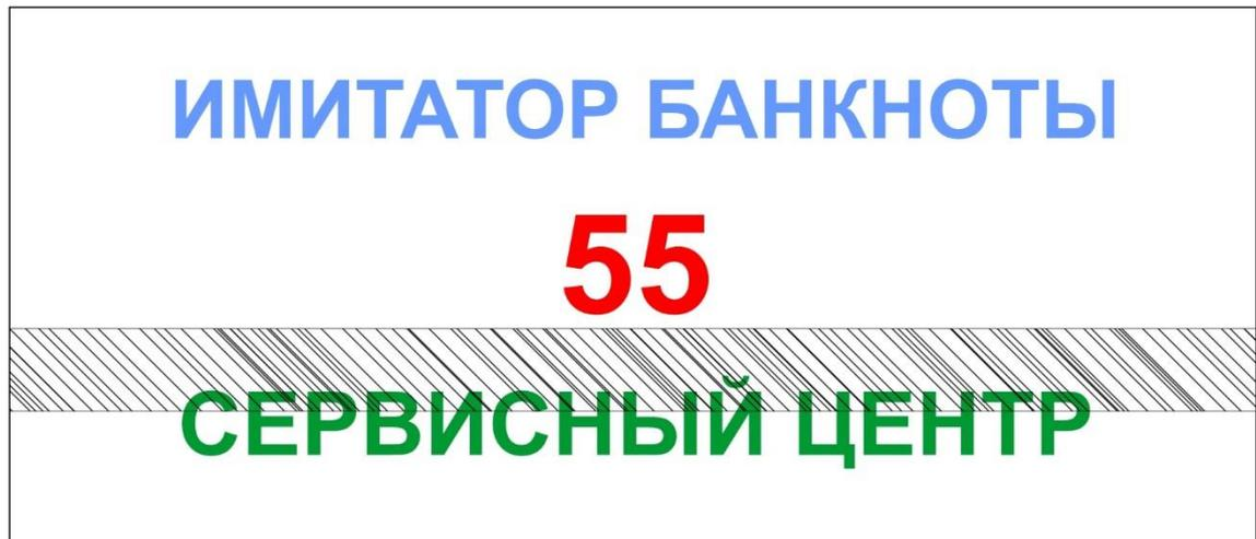
Для изготовления тестовых образцов имитаторов банкнот по ветхости со штампом, в центральной части левой или правой четверти имитатора банкноты проставляется штамп размером 5 x 20 мм. (рис 14)
