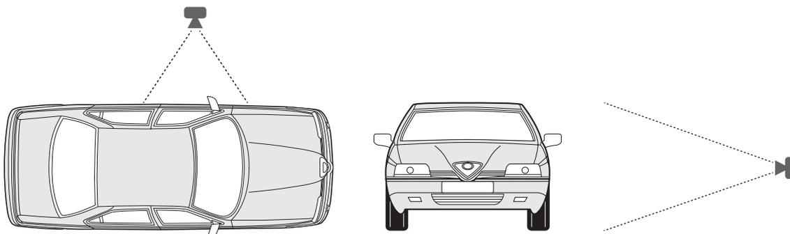
РИС. 2. СХЕМА ВЫПОЛНЕНИЯ ФОТОСЪЕМКИ ПОВРЕЖДЕННОЙ ЛЕВОЙ ПЕРЕДНЕЙ ДВЕРИ
